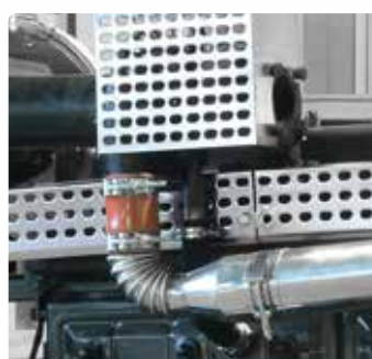
Защитные решетки на горячих деталях двигателя
